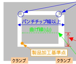
2箇所ポジションに0.2mm位の両側マイクロジョイントを付けて加工を行います。
