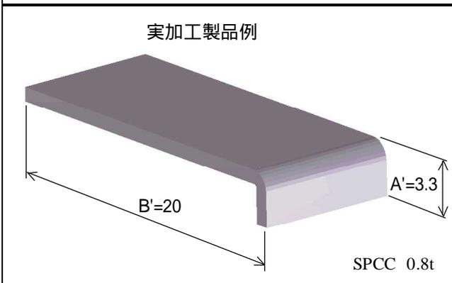
実加工を行い、寸法補正が必要な場合はインチバンド専用計算ソフトで下図のように実測値を入力して補正值算出後、手順1の作業からプログラムを再作成して下さい。
